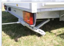
Ausfahrbare Stützen sorgen für einen festen Stand
