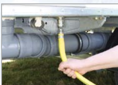
Einfacher Bajonettanschluss für die Frischwasserzufuhr
