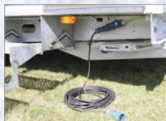
Stromanschluss 230 V / 16 A mit Verlängerungskabel
